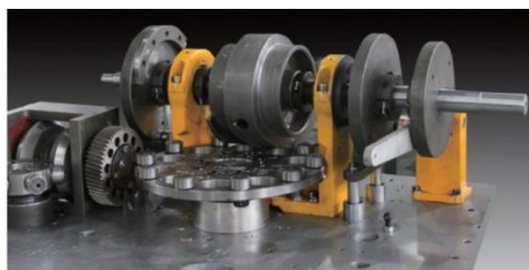
Conjunto de leva de indexación doble
