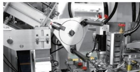
Estación de alimentación de papel rotativo
