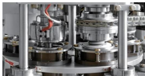
Estación de conformado de doble canto
